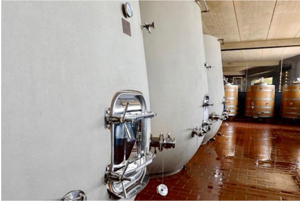
Depósitos de cemento y troncocónicas de madera en Herència Altés
